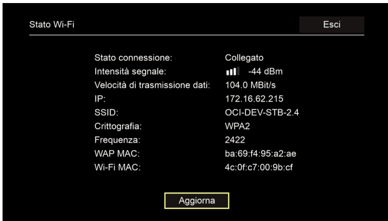
Figura 8: Panoramica sullo stato della WLAN
