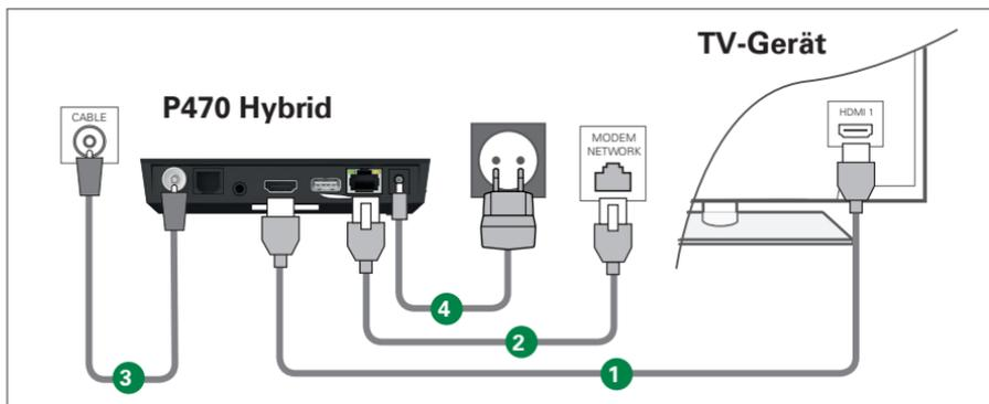
Abbildung 2 - Kabelverbindungen
